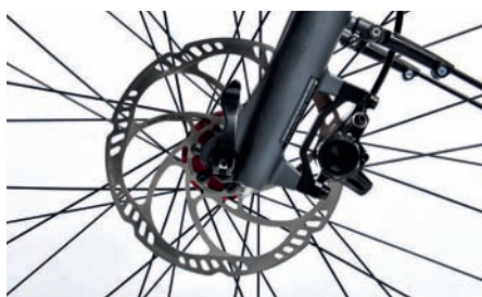
Hydraulische Scheibenbremse Magura MT2 mit zwei Kolben.
